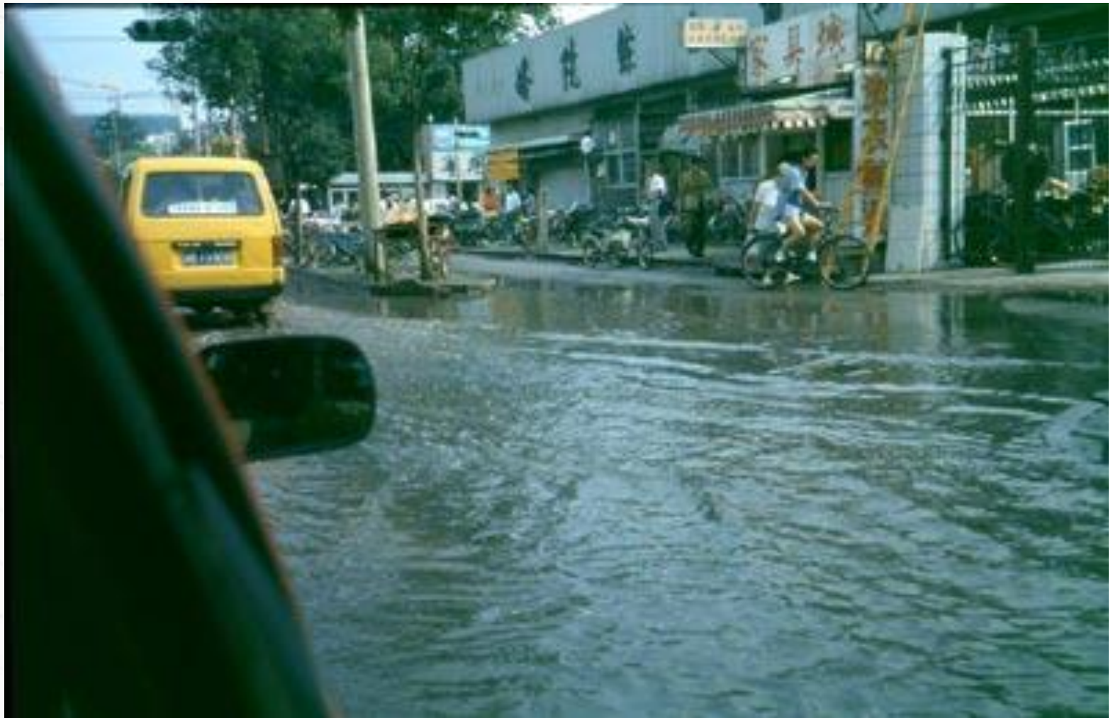
硬化地面在城市中造成的雨水滞留
